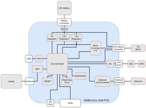
Figure 7: Future SIMBA PCB Modules Block Diagram.
